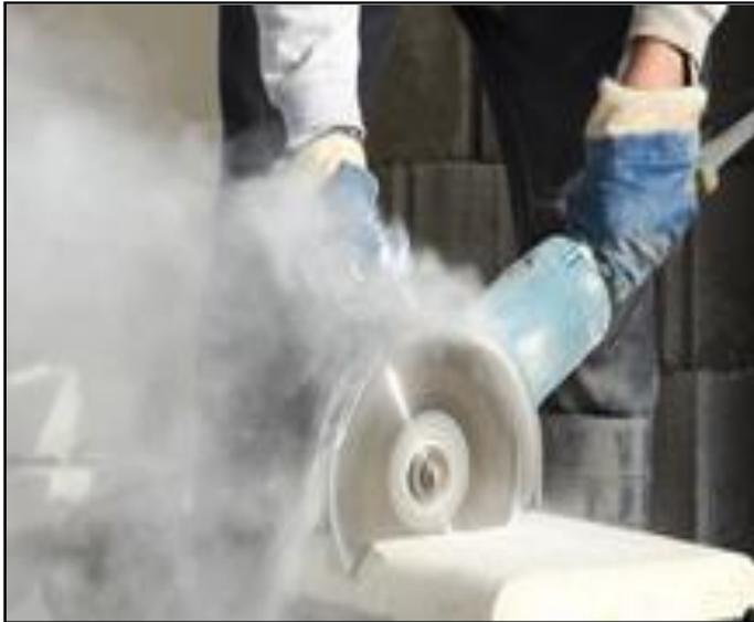
干式切割、研磨或抛光石材会产生含有非常高的RCS粉尘。这些工作需要配备水控制处理或内置排气通风系统的工具。
